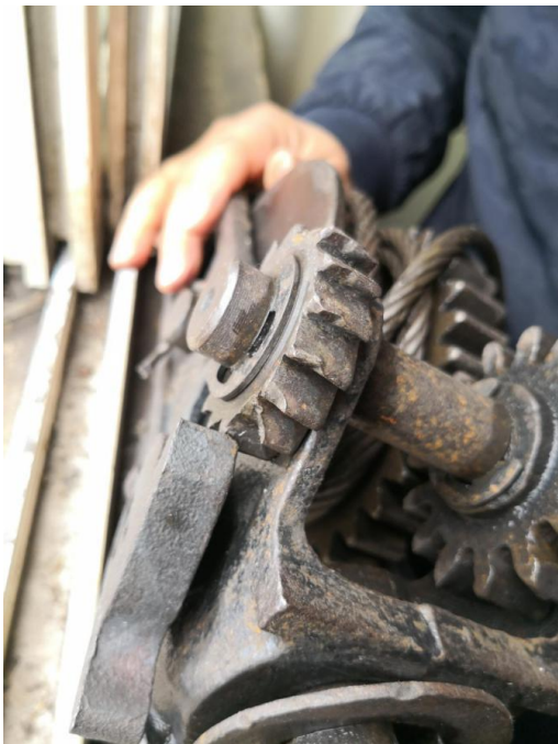
图三：回柱器棘轮有3个齿部分缺失
