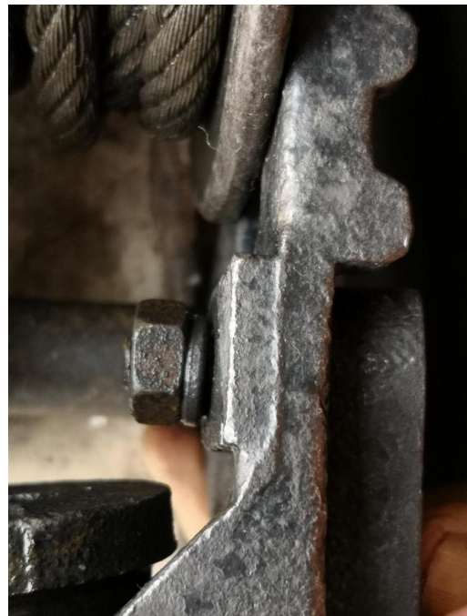
图四：回柱器棘爪固定螺丝松动
